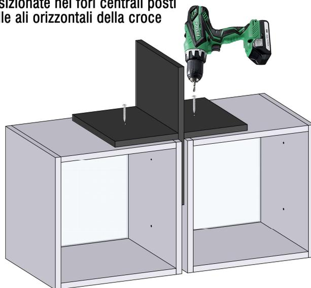
3. Con una miccia diam.5 mm, utilizzando le preforature sui fianchi dei cubolotti, praticare un foro passante CUBO - CROCE - CUBO
