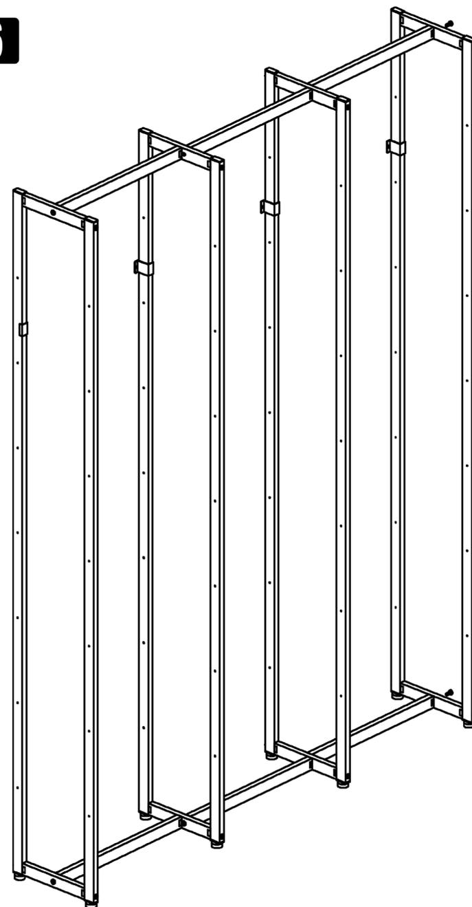
Montare le traverse orizzontali inferiore e superiore del terzo modulo di scaffalatura utilizzando i fori centrali dei traversini
