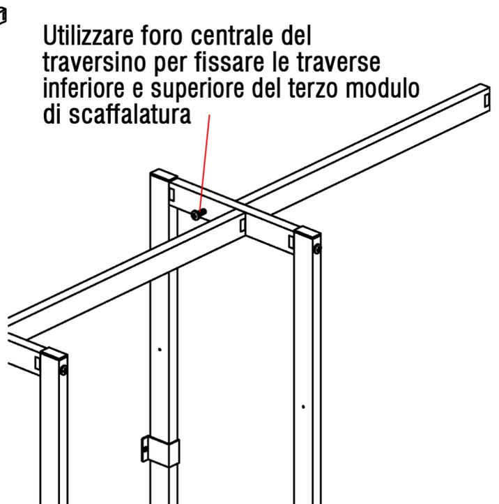
A montaggio ultimato le traverse inferiori e superiori dei moduli dispari (primo, terzo, quinto ecc.) avranno i bulloni M8 passanti per i fori centrali originali dei traversini, mentre i moduli pari (secondo, quarto ecc.) li avranno passanti per i nuovi fori praticati in fase di montaggio a distanza di 25 mm da quelli centrali
