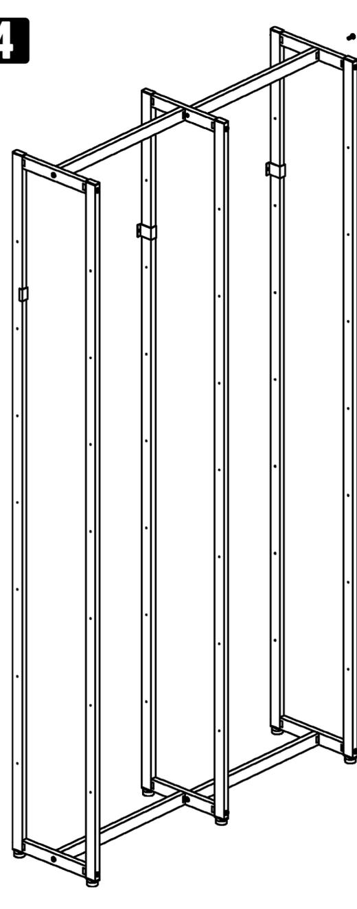
Montare le traverse orizzontali inferiore e superiore del secondo modulo di scaffalatura utilizzando i fori spostati di 25 mm praticati sui traversini
