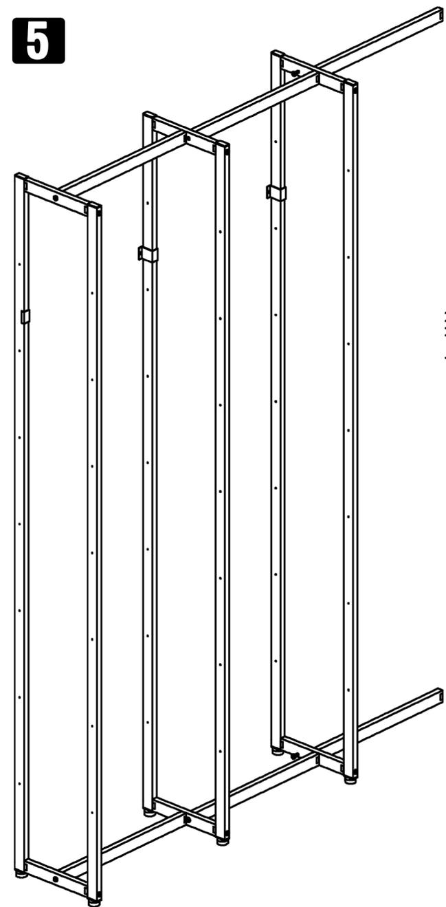
Utilizzare foro centrale del traversino per fissare le traverse inferiore e superiore del terzo modulo di scaffalatura
