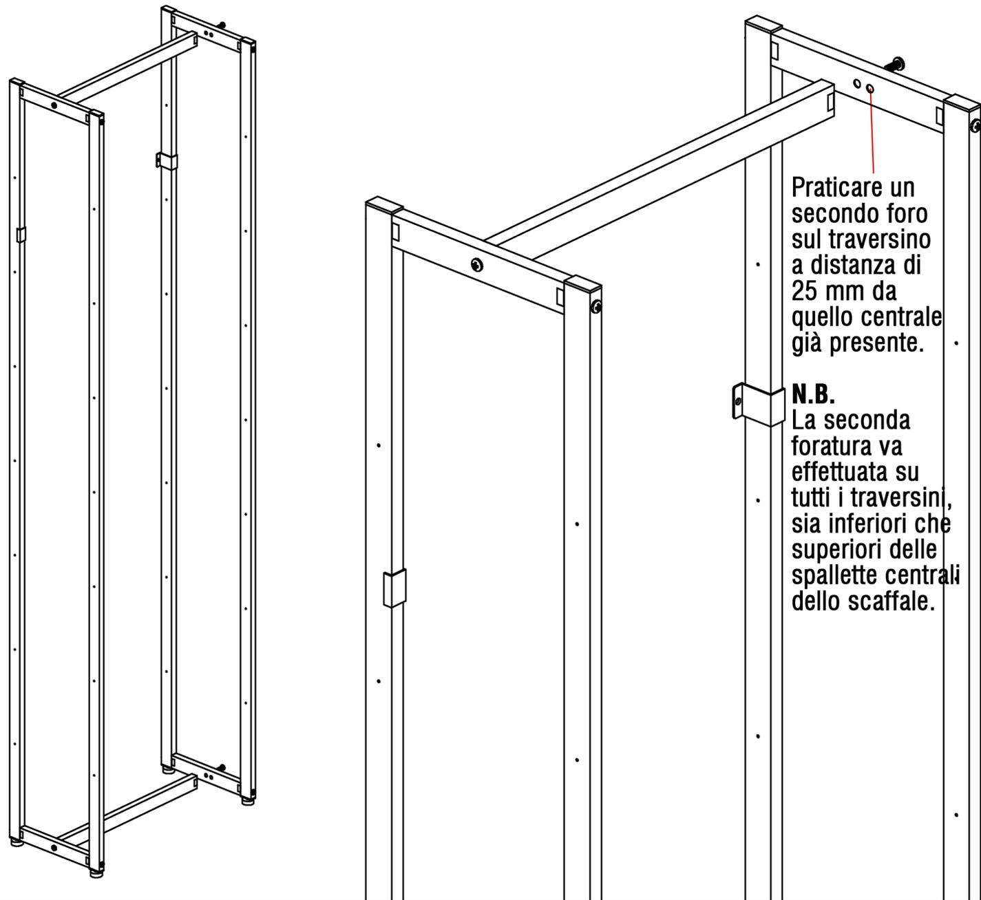
Montare la prima spalletta e fissare le traverse inferiore e superiore mediante i bulloni M8 passanti per il foro centrale dei traversini
