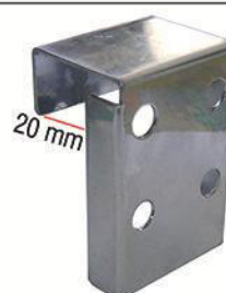
descrizione: STAFFETTA FORATA PER TUBO QUADRO codice: TG-STFFOR_TQ misura: L.4,2 x P.3,3 x H.6 cm - per tubo sez.20x20 mm finitura: cromato
