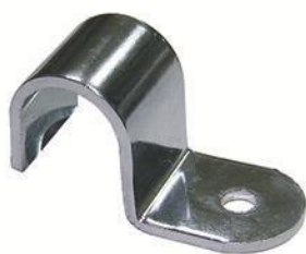
descrizione: STAFFETTA R/PIANO codice: JK-STFPNOV misura: Per tubo ovale 30x15 mm finitura: cromato
