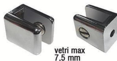
descrizione: MORSETTO QUADRO codice: YL-073 misura: L.21,5 x P.17 x H.18 mm finitura: cromato
