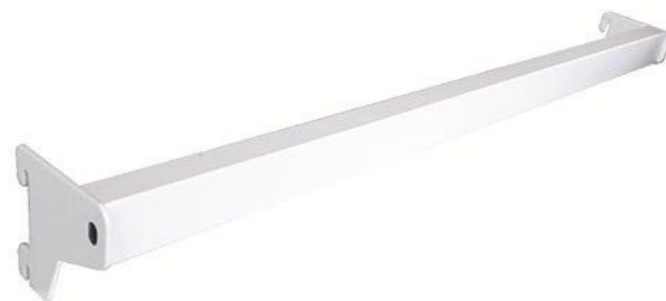
descrizione: BARRA IN TUBO RETTANGOLARE codice: SM-BR_RT.58 misura: L.58 x P.4 cm - tubo rettangolare sez.20x30 mm finitura: bianco RAL 9010 - nero RAL 9004
