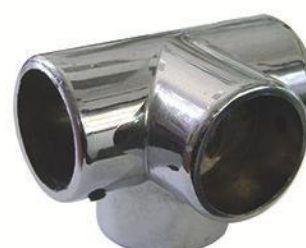
descrizione: GIUNTO TONDO ESTERNO A 4 VIE codice: TG-GNTTD.4V misura: L.6 x P.4,5 x H.4,5 cm - Per tubo diam. 25 mm finitura: cromato
