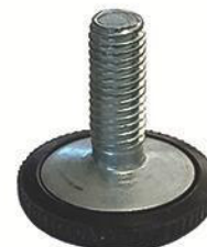
PIEDINO CON BULLONE PIEDINO CON BULLONE TG-PDNCONS.M8 TG-PDNCONS.M10 H.1 - Diam.2,8 cm - filet. M8 H.1 - Diam.3 cm - filet. M10 zincato zincato
