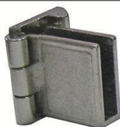
descrizione: CERNIERA INFERIORE codice: TG-CRN.TB.INF misura: L.2,8 x P.2,5 x H.2,8 cm - vetri max 6 mm finitura: zincato
