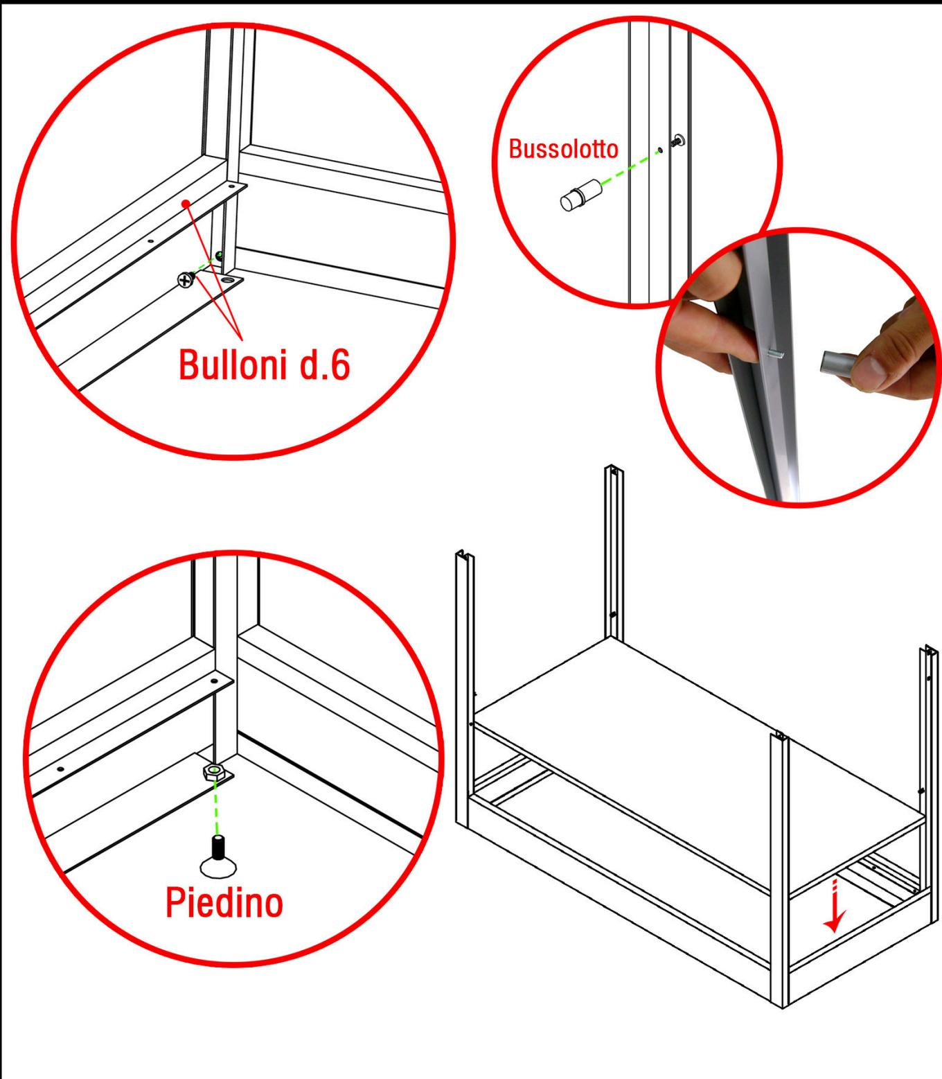
Completare il montaggio dello zoccolo inferiore posizionando gli altri 2 montanti a 2 vie e il secondo frontale. Chiudere la struttura ripetendo le azioni della fase 01 e 02. Al termine avvitare i 4 piedini in dotazione nei dadini saldati sulle alette dei 2 frontali e inserire il piano di base. Fissare i bussolotti reggipiano ai montanti a 2 vie inserendo le viti diam. 4 in dotazione nei fori presenti sull' aletta interna dei montanti.
