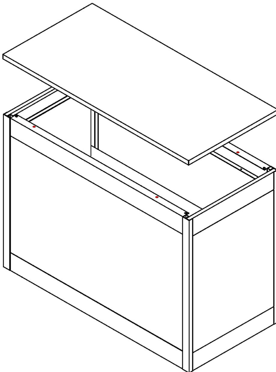
**Posizionare il top sullo zoccolo superiore per il fissaggio**
