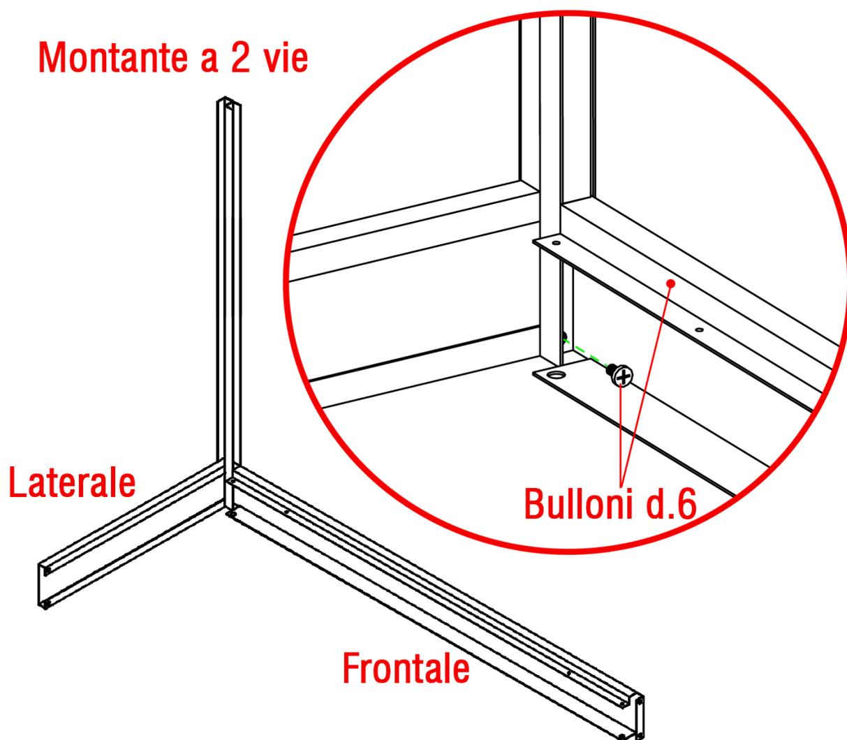
Posizionare il laterale e il frontale di metallo nel montante a 2 vie facendo combaciare i buchi. Bloccare i 3 oggetti mediante i bulloni diam.6 in dotazione (in entrambi i fori). Le viti, passanti attraverso i fori del frontale e del montante, si avvitano nei rivetti filettati solidali al laterale.
