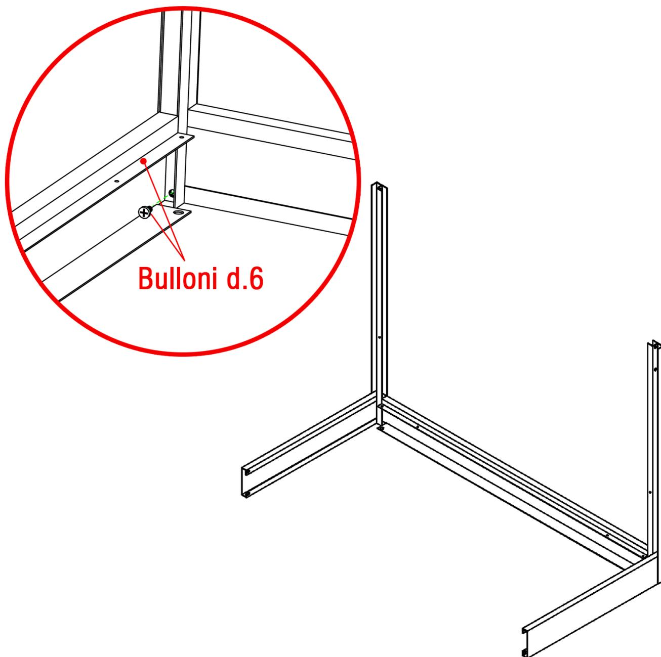
Ripetere le operazione della fase 01, posizionando il frontale e un secondo laterale nel secondo montante a 2 vie facendo combaciare i buchi. Bloccare i 3 oggetti mediante i bulloni diam.6 in dotazione (in entrambi i fori).
