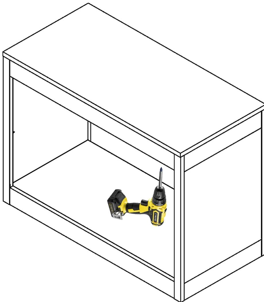
Fissare il top mediante viti per legno dall' interno del banco poste nei fori praticati sull'aletta superiore dello zoccolo durante la fase 6 (cerchi rossi nell' immagine).
