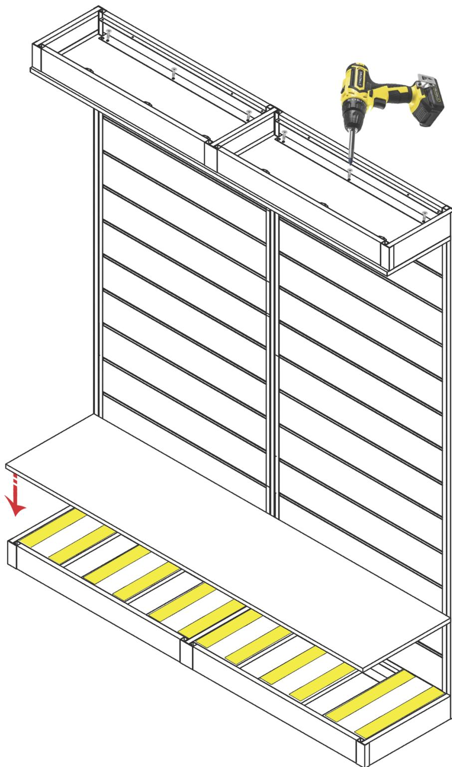
Fissare il piano porta faretto allo zoccolo superiore mediante le viti per legno in dotazione, inserite nei fori precedentemente praticati.
