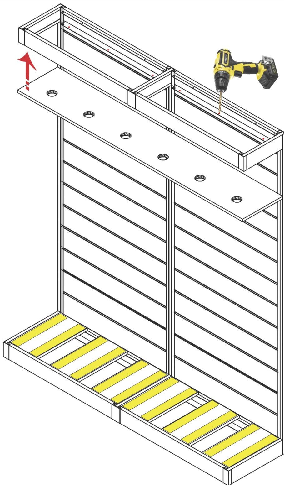
Completare il montaggio dello zoccolo superiore (cappello) mettendo i montanti a 2 e 3 vie h.10 cm esterni e i frontali, sempre con l'aletta larga rivolta verso il basso. Praticare 3 fori nella parte esterna di ciascun frontale per poter fissare il piano porta faretti. Inserire nello zoccolo inferiore i supporti di legno sui quali si fisserà la controbase di legno grazie al biadesivo (fasce gialle nell'immagine).
