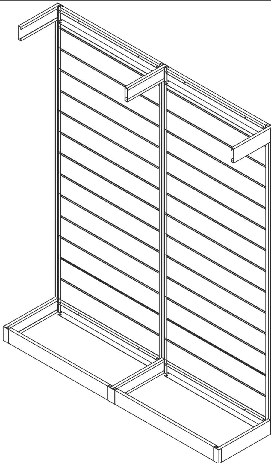
Montare lo zoccolo superiore (cappello) in modo analogo a quanto fatto per quello inferiore nelle fasi 01 - 02 - 03 - 04. Lo zoccolo superiore deve essere montato nello stesso identico modo di quello inferiore, con i frontali aventi l'aletta più larga rivolta verso il basso in modo, successivamente da poter fissare il piano porta faretti.
