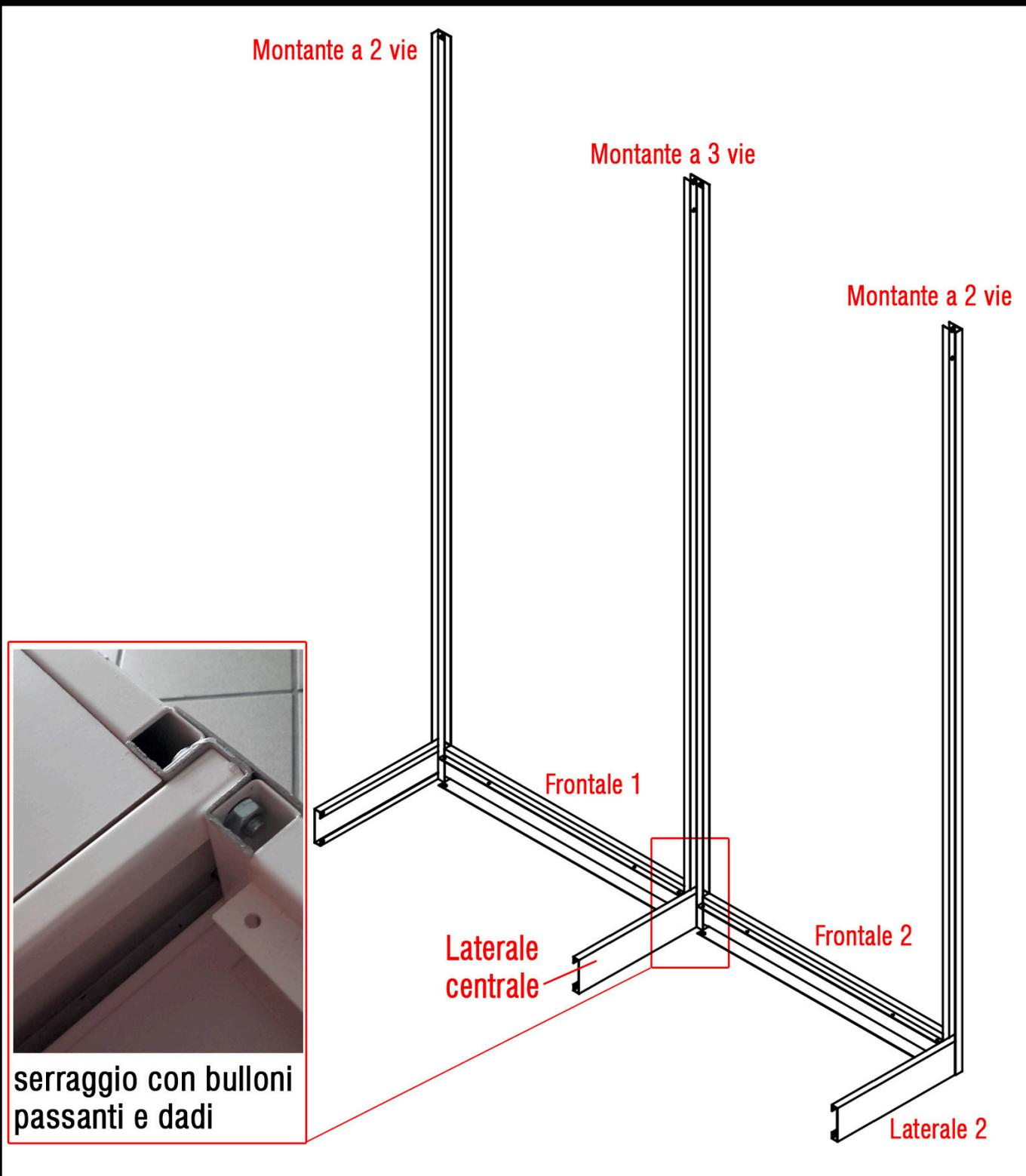
Posizionare il il frontale 2 nel montante a 3 vie. Bloccare i frontali 1 e 2 al montante a 3 vie e al laterale centrale mediante i bulloni M8x40 e dadi come da foto sopra. Posizionare il secondo montante a 2 vie tra il frontale 2 e il laterale 2 facendo combaciare i buchi . Bloccare i 3 oggetti mediante i bulloni diam.6 in dotazione (in entrambi i fori). Le viti, passanti attraverso i fori del frontale 2 e del montante, si avvitano nei rivetti filettati solidali al laterale 2.
