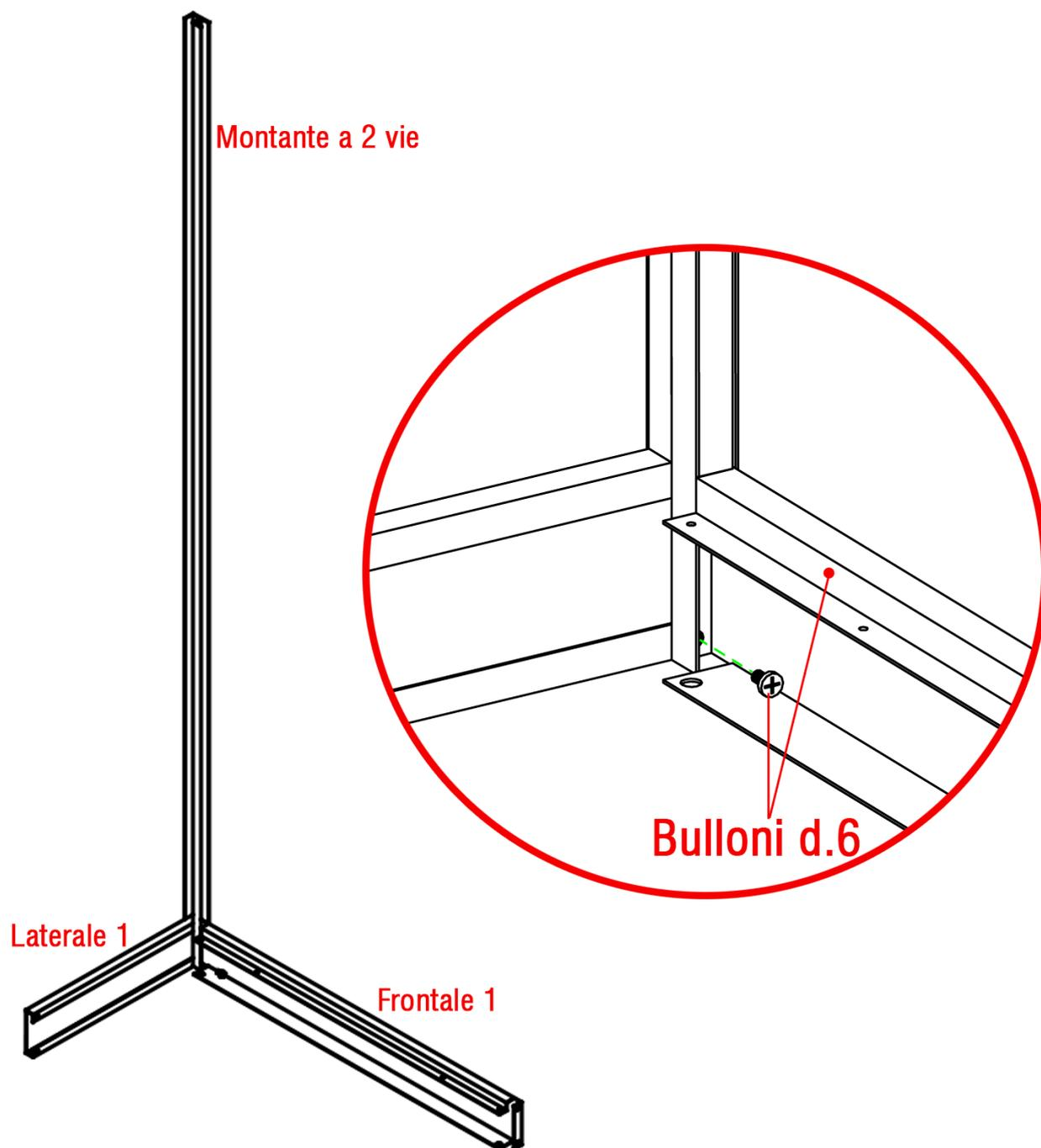
Posizionare il laterale 1 e il frontale 1 di metallo nel montante a 2 vie facendo combaciare i buchi. Bloccare i 3 oggetti mediante i bulloni diam.6 in dotazione (in entrambi i fori).
