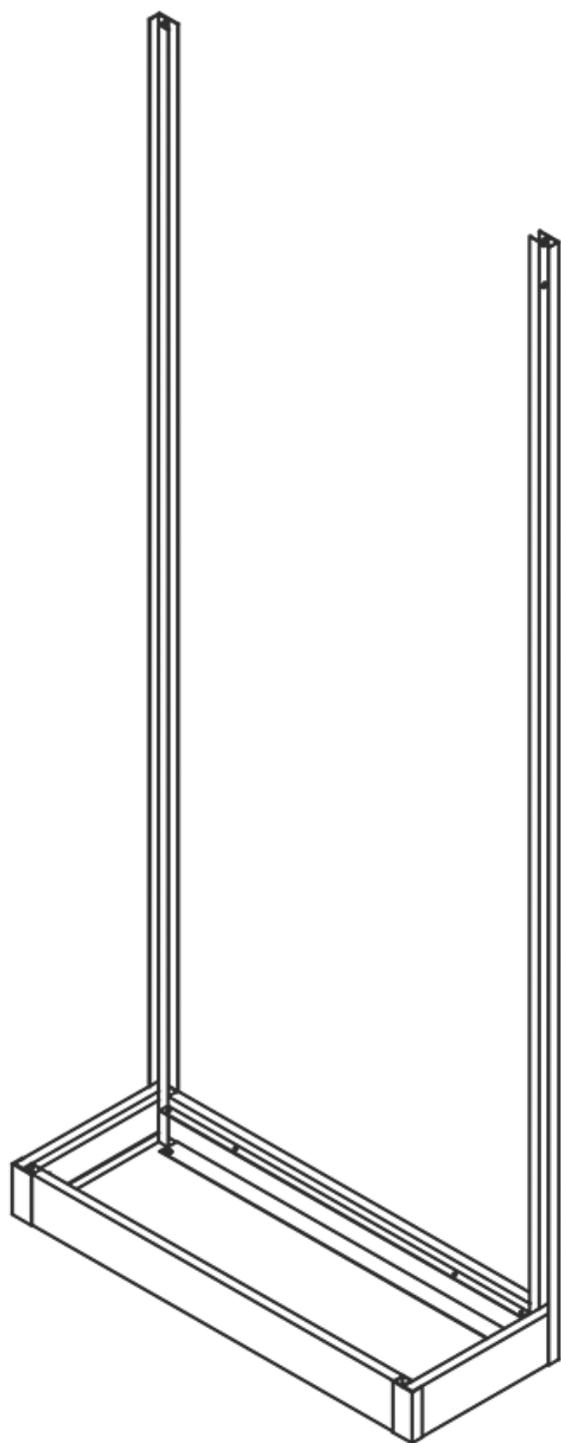
Completare il montaggio dello zoccolo inferiore posizionando i 2 montanti anteriori h.10 cm a 2 vie e il secondo frontale. Chiudere la struttura ripetendo le azioni della fase 01 e 02.
