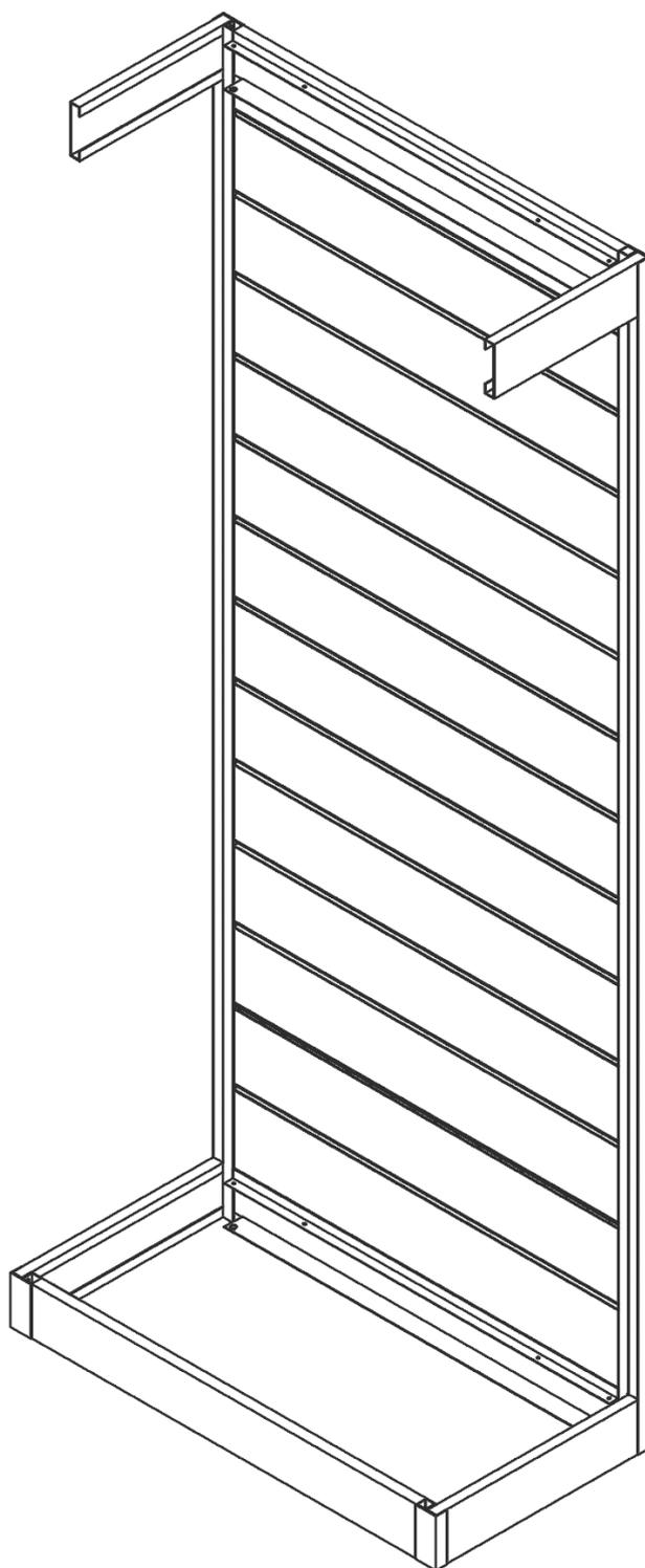
Montare lo zoccolo superiore (cappello) in modo analogo a quanto fatto per quello inferiore nelle fasi 01 - 02 -03. Lo zoccolo superiore deve essere montato nello stesso identico modo di quello inferiore, con i 2 frontali aventi l'aletta più larga rivolta verso il basso in modo, successivamente da poter fissare il piano porta faretti.
