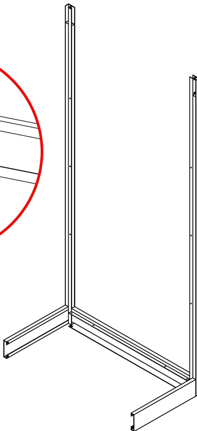
Ripetere le operazione della fase 01, posizionando il frontale e un secondo laterale nel secondo montante a 2 vie facendo combaciare i buchi. Bloccare i 3 oggetti mediante i bulloni diam.6 in dotazione (in entrambi i fori).
