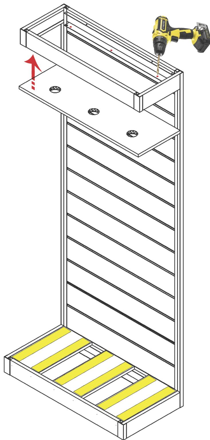
Completare il montaggio dello zoccolo superiore (cappello) mettendo i 2 montanti a 2 vie h.10 cm esterni e il secondo frontale, sempre con l'aletta larga rivolta verso il basso. Praticare 3 fori nella parte esterna di ciascun frontale per poter fissare il piano porta faretto. Inserire nello zoccolo inferiore i supporti di legno sui quali si fisserà la controbasse di legno grazie al biadesivo (fasce gialle nell'immagine).
