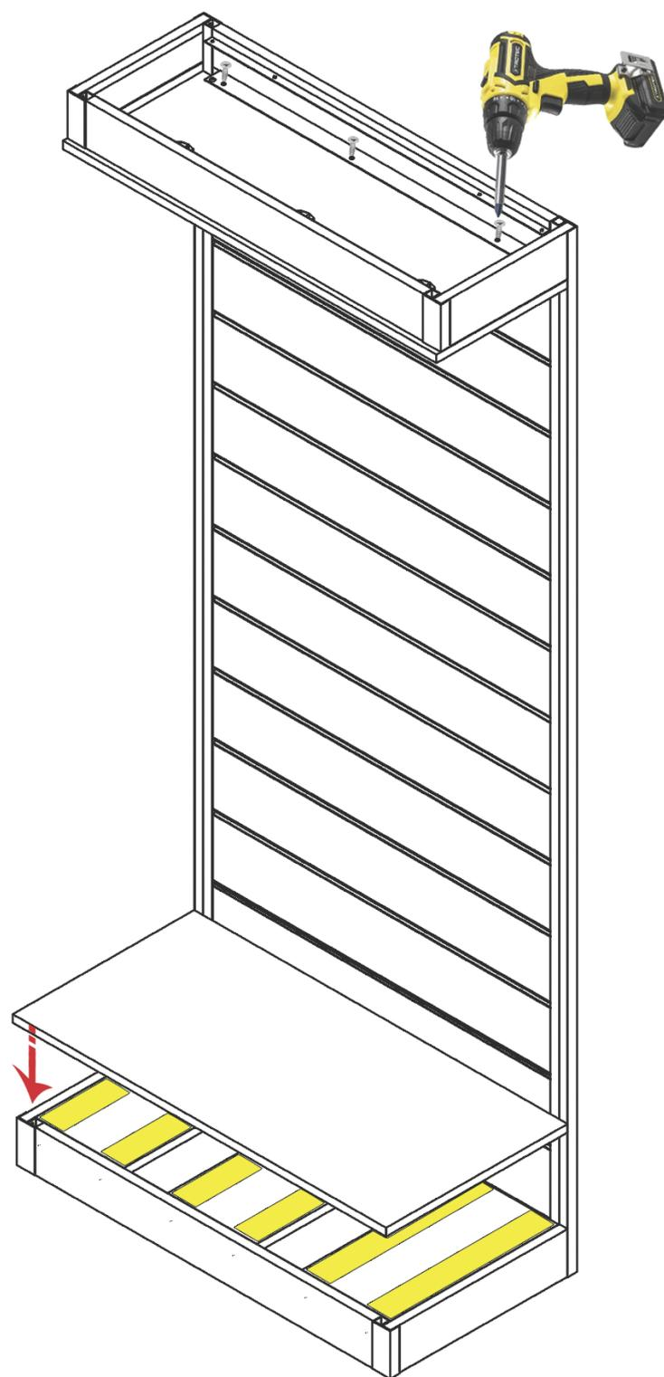
Fissare il piano porta faretti allo zoccolo superiore mediante viti per legno in dotazione, inserite nei fori precedentemente praticati.
