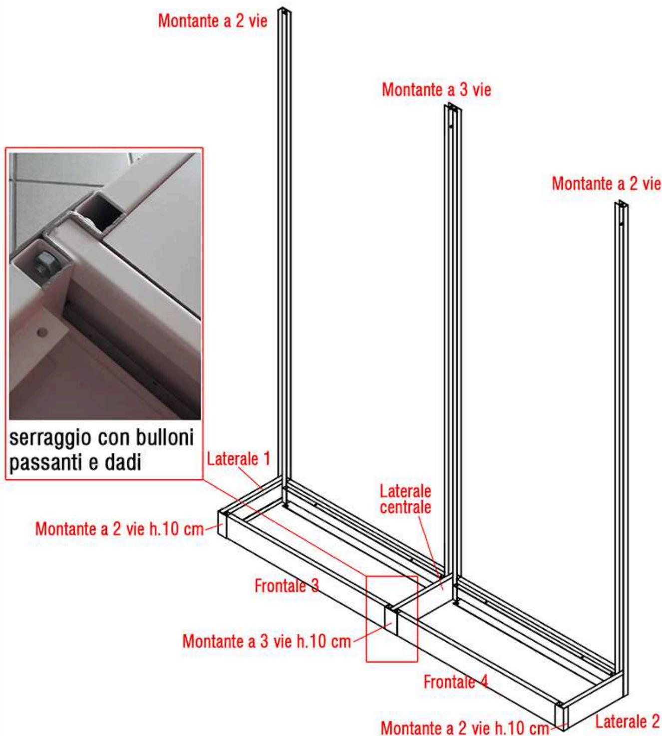
Posizionare i 3 montanti anteriori h.10 cm e i frontali 3 e 4. Ripetere le stesse operazioni di serraggio delle fasi 2 e 3. Il frontale 3 è fissato a sinistra al montante a 2 vie h.10 cm e al laterale 1 mediante i bulloni diam.6 da avvitare nei rivetti filettati del laterale 1 mentre a destra è fissato al montante a 3 vie e al frontale 4 mediante i bulloni passanti e dadi come da foto (i bulloni attraversano anche i fori del laterale centrale).
