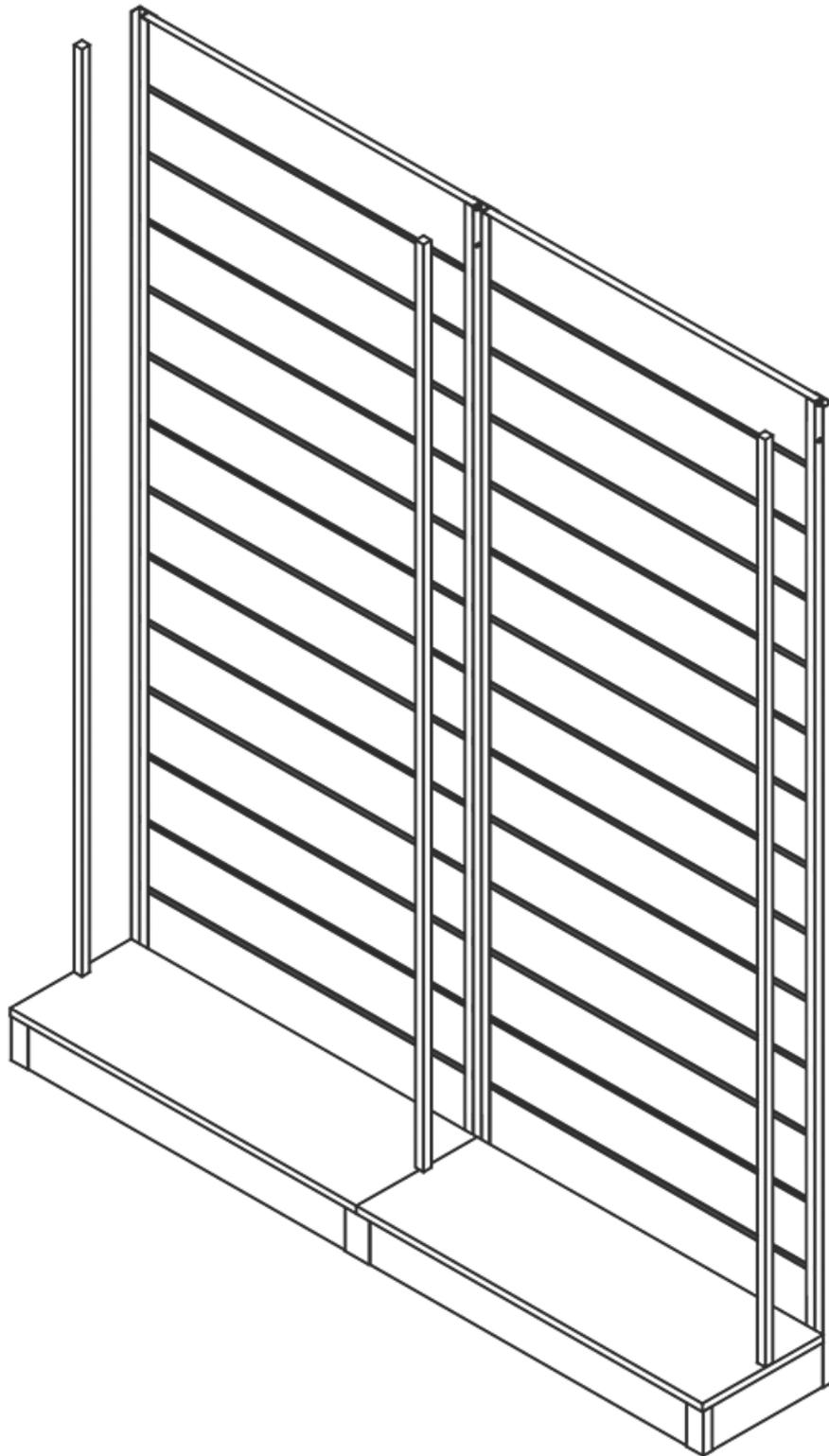
Completare il montaggio inserendo i 3 tubolari di finitura nei montanti posteriori. Fissarli mediante il nastro biadesivo applicato su uno dei lati dei tubolari
