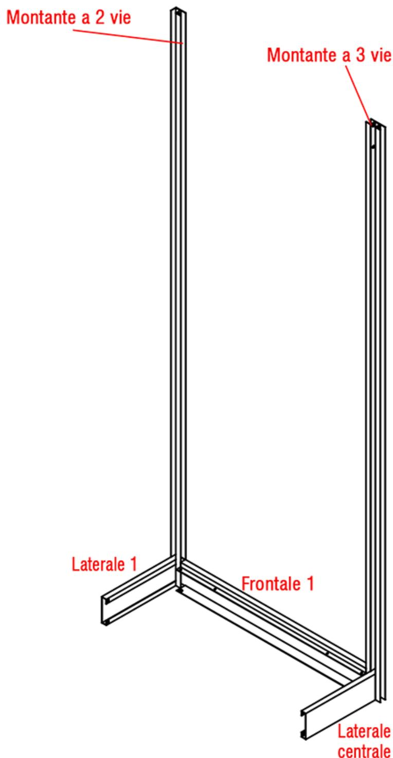
Posizionare il montante a 3 vie e il laterale centrale (caratterizzato da non avere i rivetti filettati come il laterale 1 ma dei fori passanti)
