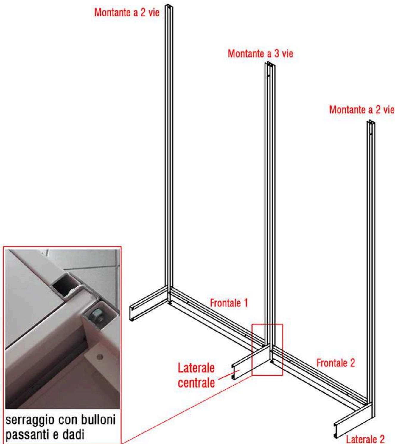
Posizionare il il frontale 2 nel montante a 3 vie. Bloccare i frontali 1 e 2 al montante a 3 vie e al laterale centrale mediante i bulloni M8x40 e dadi come da foto sopra.
