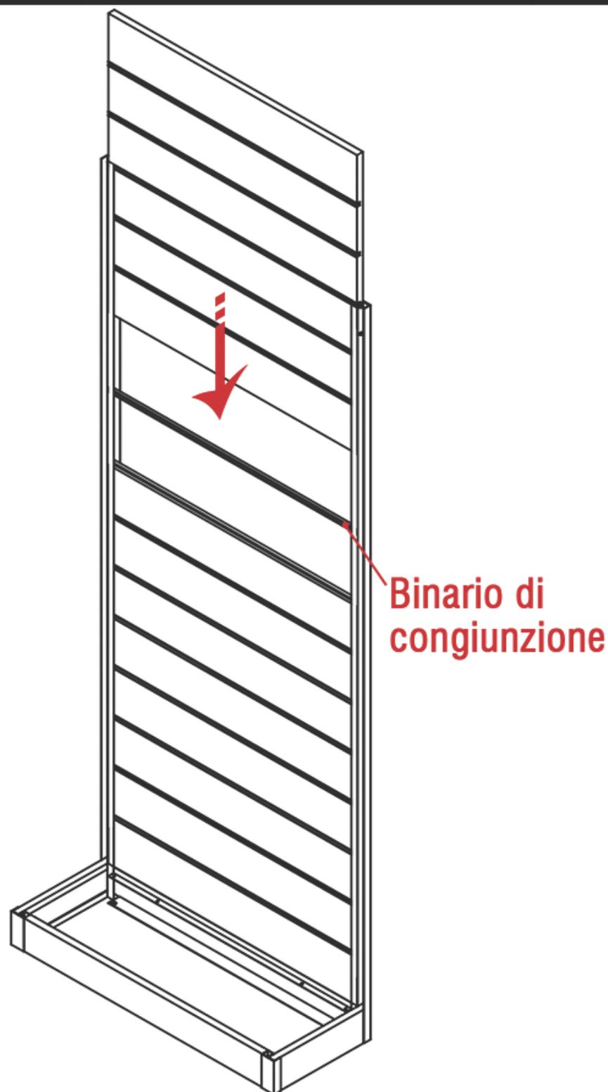
Inserire lo schienale dogato nei montanti a 2 vie posteriori. Lo schienale è formato da 2 elementi con il binario di congiunzione da inserire tra i due lati con la mezza fresata.
