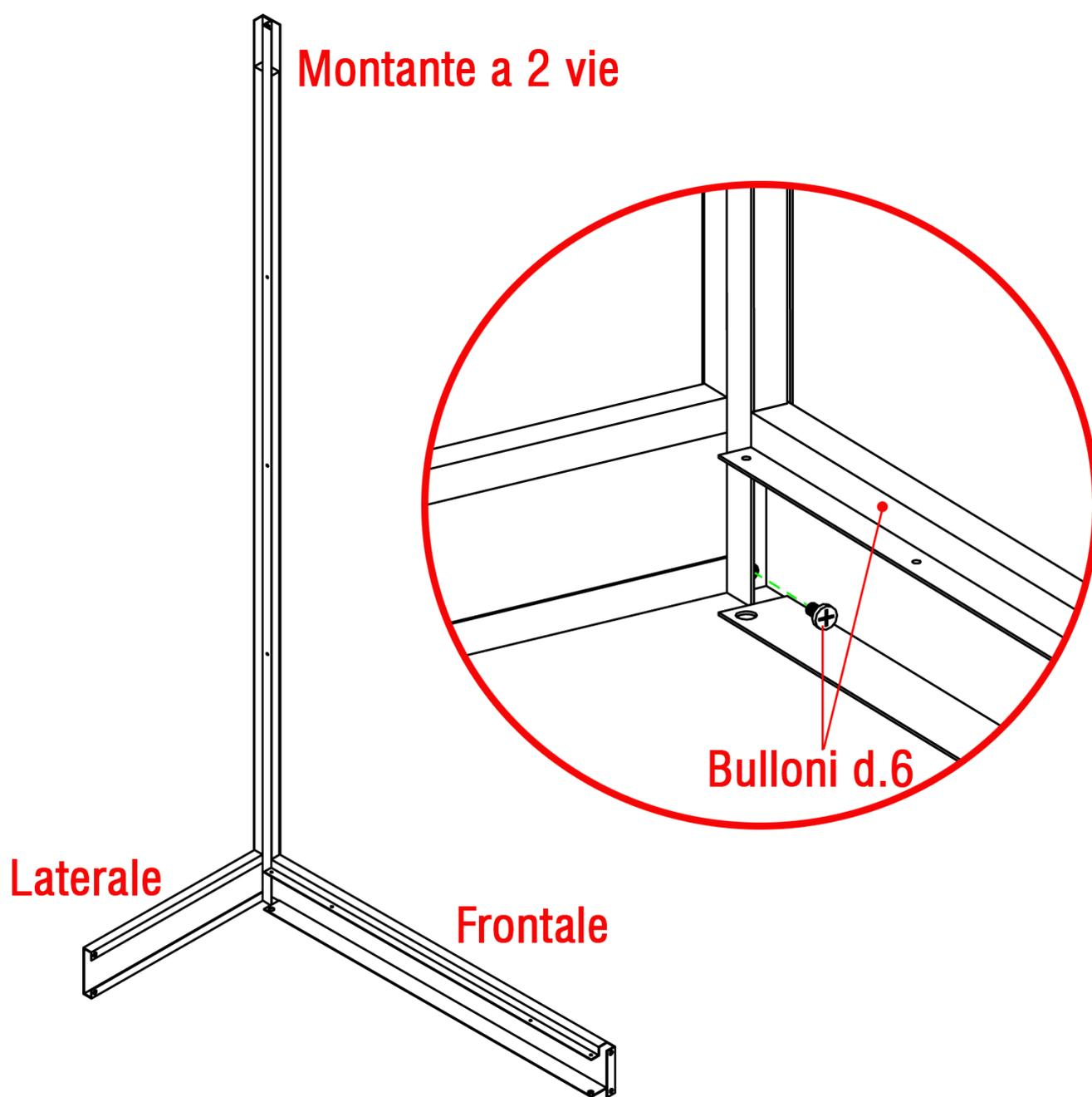
Posizionare il laterale e il frontale di metallo nel montante a 2 vie facendo combaciare i buchi. Bloccare i 3 oggetti mediante i bulloni diam.6 in dotazione (in entrambi i fori). Le viti, passanti attraverso i fori del frontale e del montante, si avvitano nei rivetti filettati solidali al laterale.
