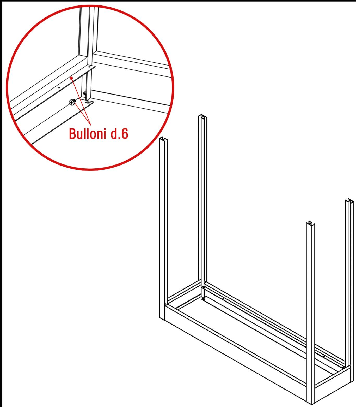
**Completare il montaggio dello zoccolo inferiore posizionando i 2 montanti anteriori h.123 cm a 2 vie e il secondo frontale. Chiudere la struttura ripetendo le azioni della fase 01 e 02.**
