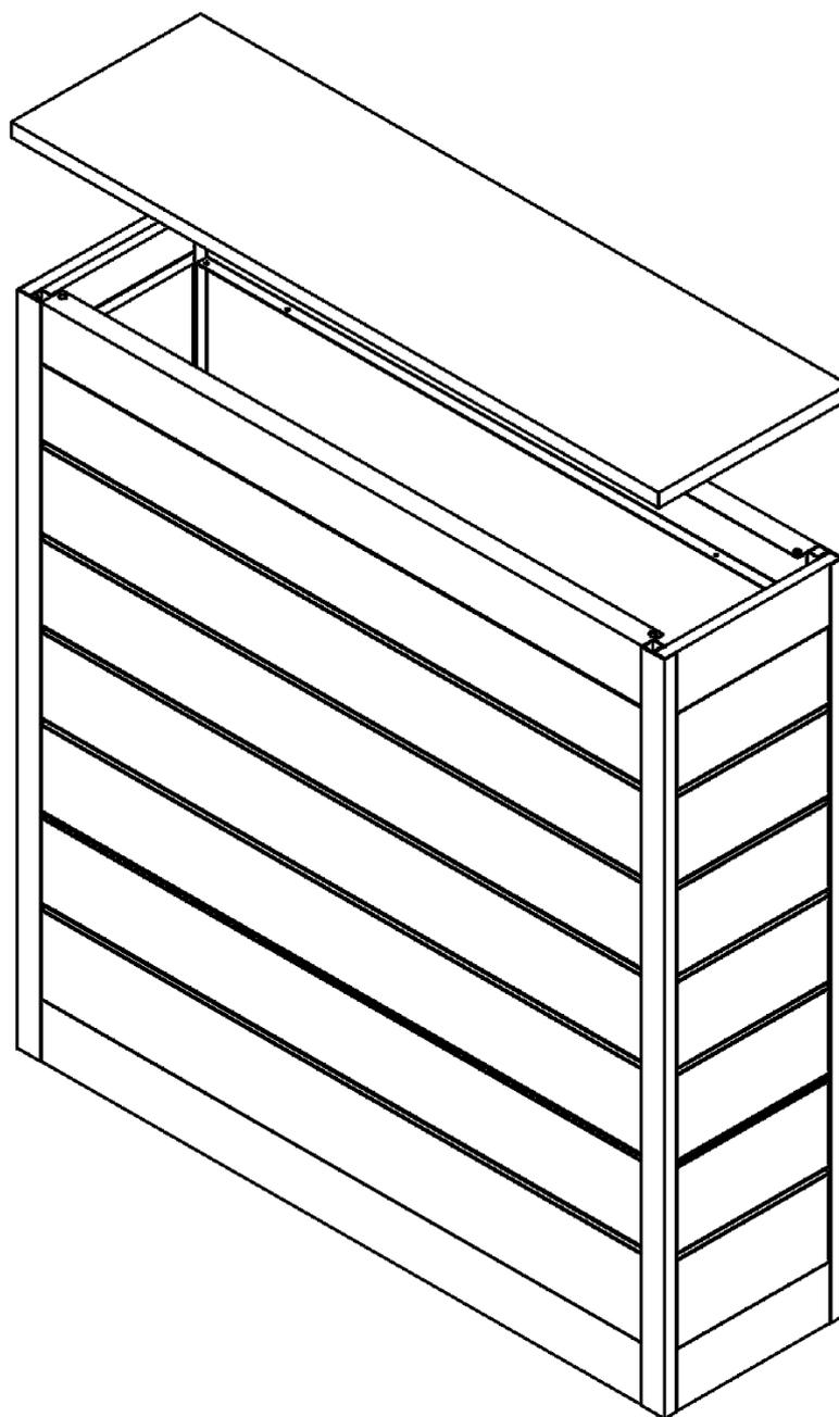
**Posizionare il top di finitura sopra la struttura fissandolo mediante il bi-adesivo già predisposto lungo il suo perimetro**
