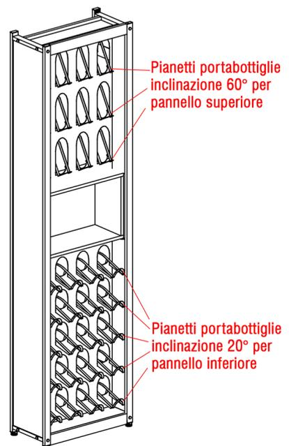
Inserire i pianetti portabottiglie nei pannelli inferiore (pianetti con inclinazione minore di 20°) e nel pannello superiore (pianetti con inclinazione maggiore di 60°). Bloccare a muro il portabottiglie mediante due squadrette fissate alla parte superiore dei montanti posteriori.
