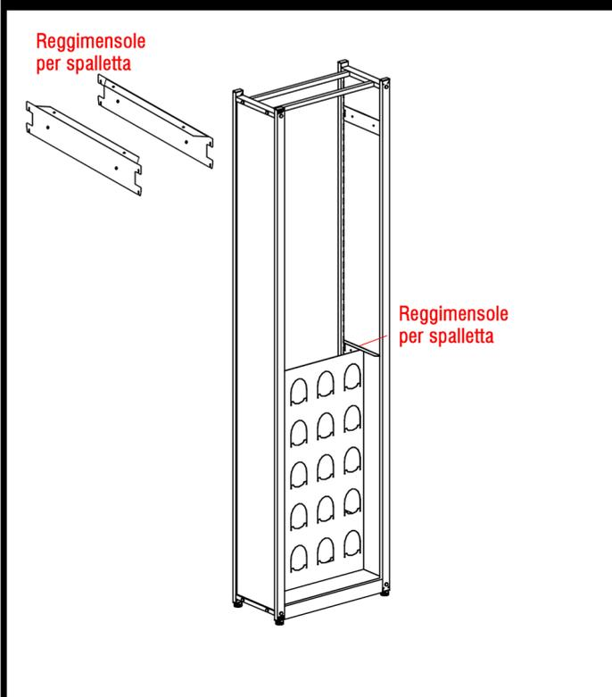
Inserire la coppia di reggimensole nelle asole dei montanti delle spallette, appena sopra il portabottiglie inferiore.
