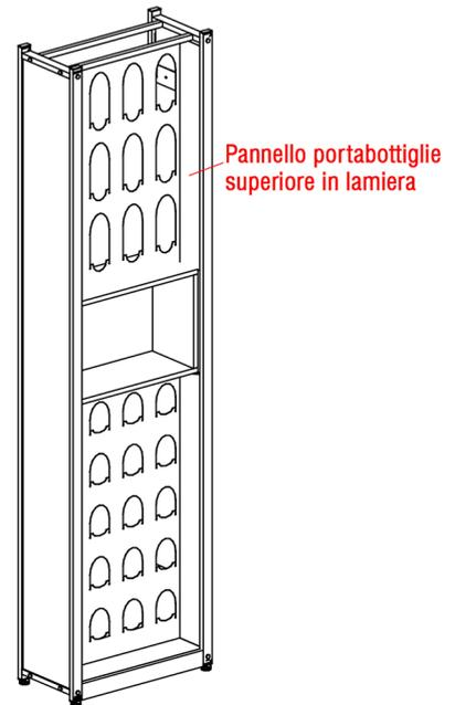
Inserire il pannello portabottiglie superiore in lamiera, fissandolo mediante i gancetti laterali ai montanti frontali delle spallette.
