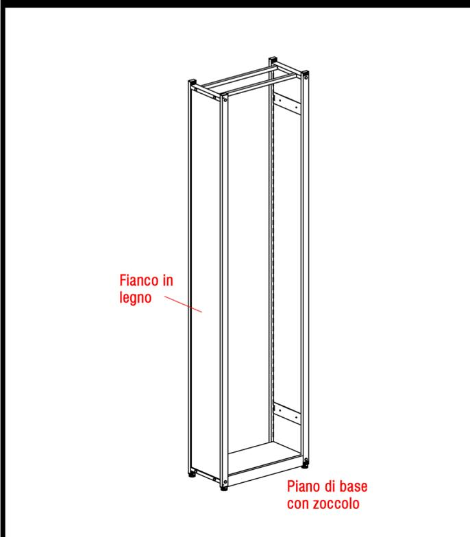
Inserire i fianchi in legno nelle spallette destra e sinistra, fissandoli mediante delle viti a legno alle spondine.
