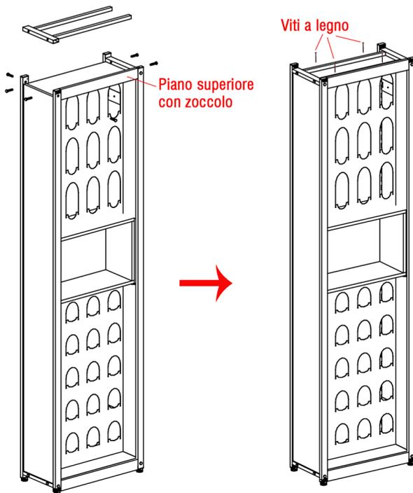
Per inserire il piano superiore con zoccolo, svitare le barre trasversali e uno dei traversini come mostrato in figura. Una volta inserito rimontare il tutto. Bloccare il piano superiore alle barre trasversali mediante delle viti a legno passanti attraverso i fori diam.5 mm presenti sulle barre.
