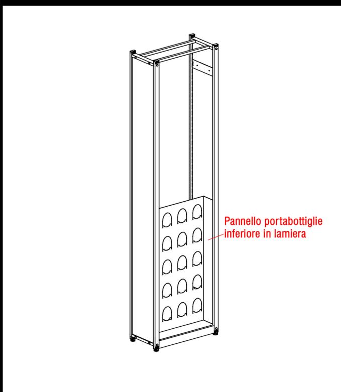
Inserire il pannello portabottiglie inferiore in lamiera, fissandolo mediante i gancetti laterali ai montanti frontali delle spallette.
