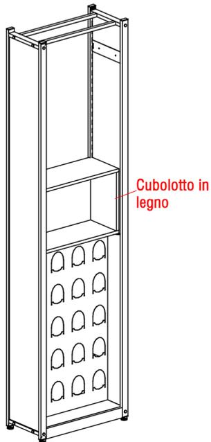
Poggiare il cubolotto in legno sulla coppia di reggimensole e fissarlo mediante viti a legno.
