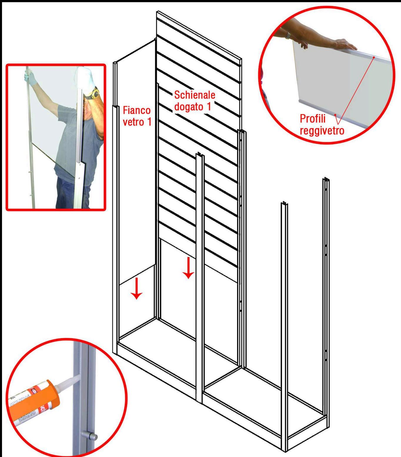
Stendere delle strisce di silicone all' interno dei montanti a 2 e 3 vie e inserire i fianchi in vetro ai quali, lateralmente, sono già stati inseriti i profili di plastica reggivetro.
