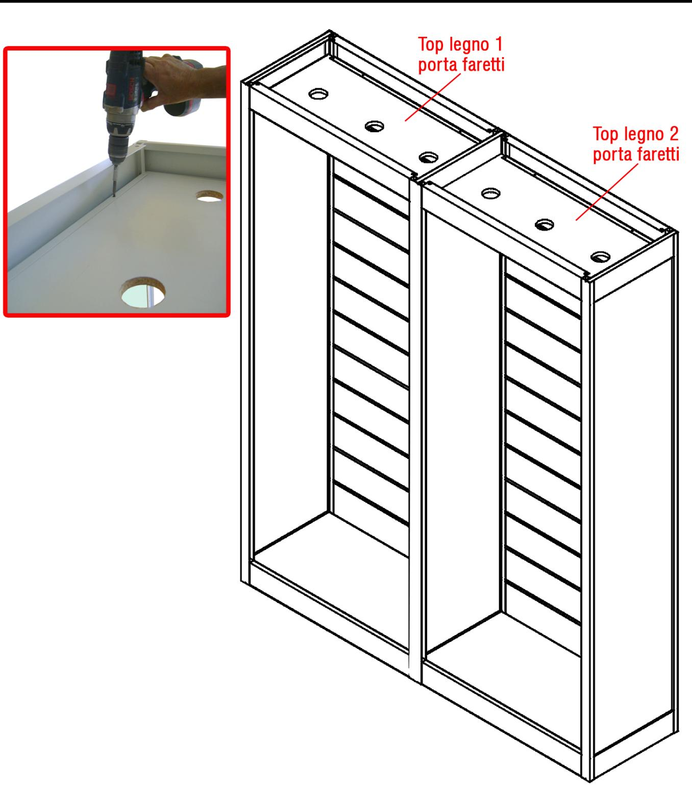
Inserire i top in legno portafaretti, ai quali in precedenza è già stato montato l' impianto luci costituito da portafaretti, faretti LED, cavetteria e trasformatore.
