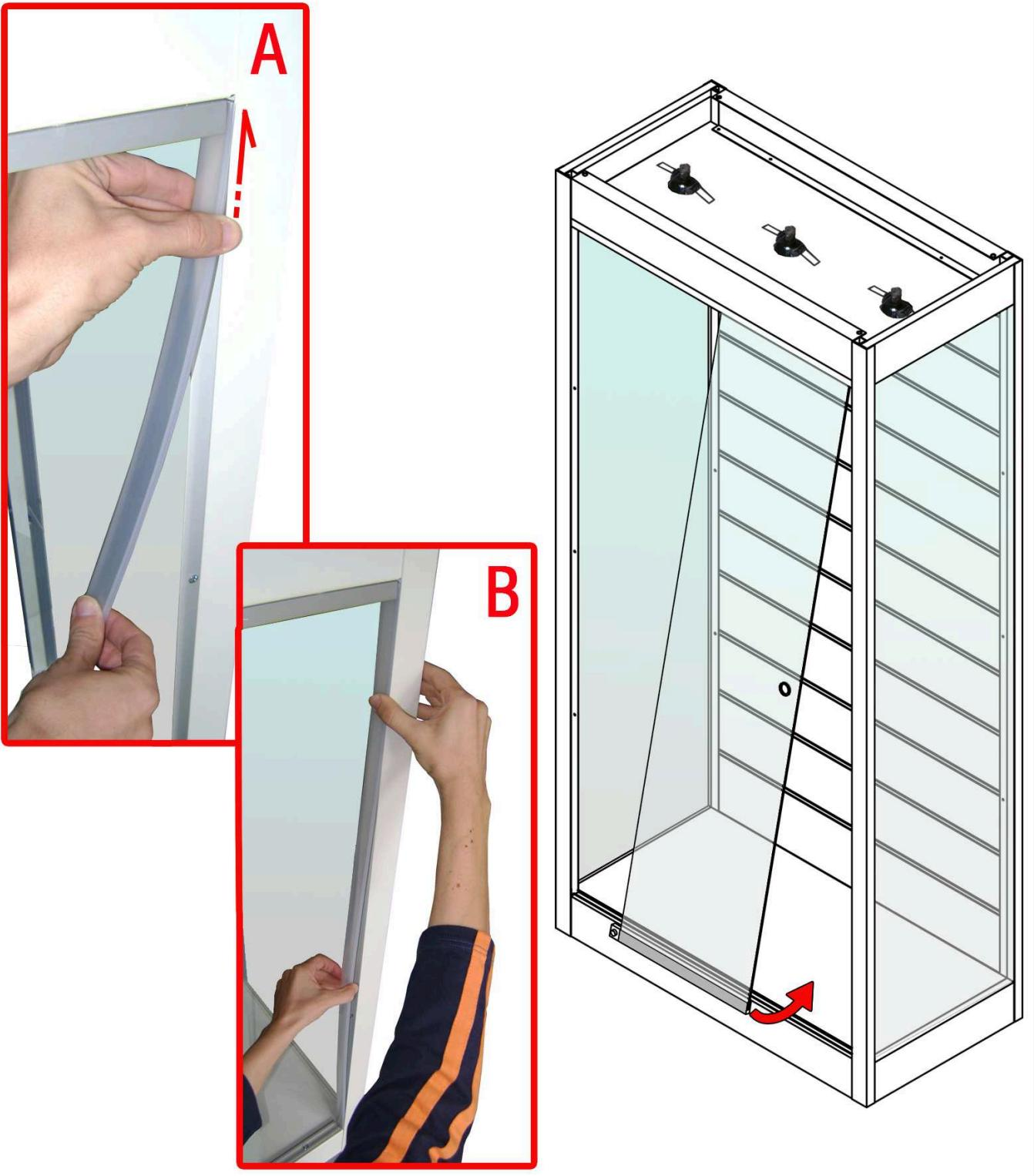
Inserire i tappi di chiusura nei montanti anteriori. Incastrare il profilo partendo dall' alto, facendolo scivolare tra il montante e il binario superiore, poi incastrare la parte inferiore progressivamente verso il basso. Mantenere saldamente il profilo incastrato fino al completo inserimento di tutto il tappo.
