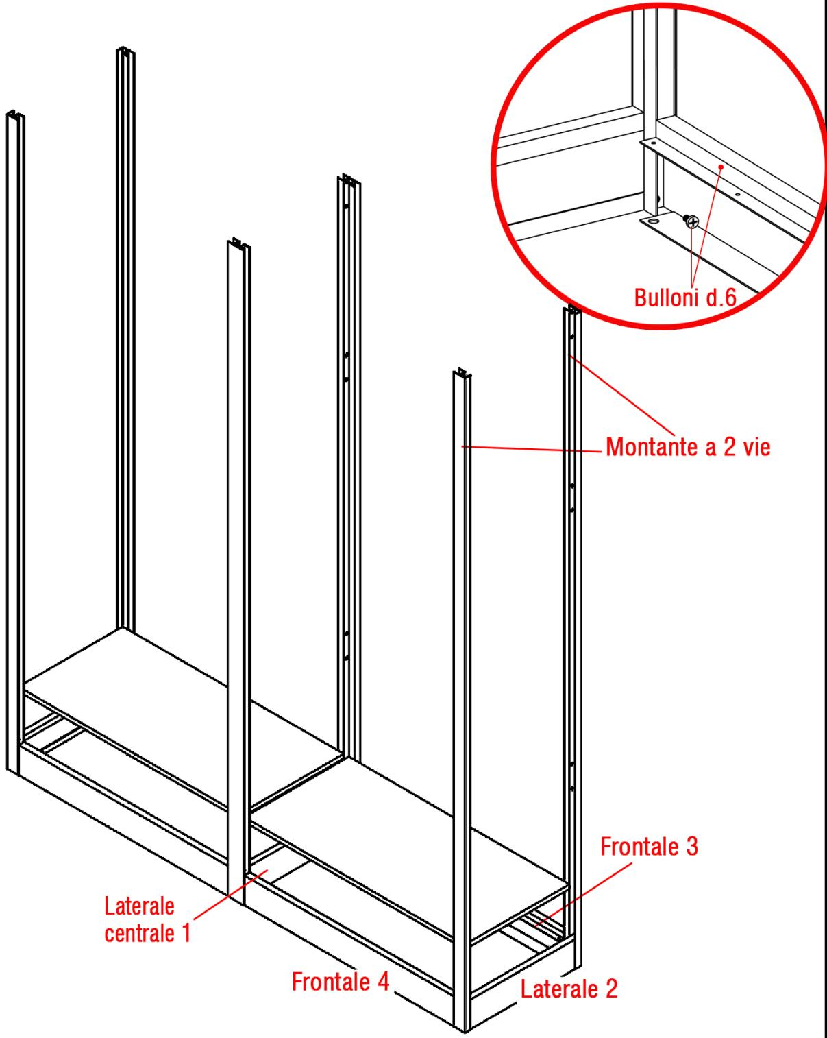
**Posizionare i montanti a 2 vie che completano la struttura. Bloccare il frontale 3 e il frontale 4 al laterale 2 mediante i bulloni diam.6 in dotazione (in entrambi i fori). Le viti, passanti attraverso i fori del frontale e del montante, si avvitano nei rivetti filettati solidali al laterale 2. Inserire i piani di base in legno, poggiangoli sulle apposite alette dei 4 frontali.**
