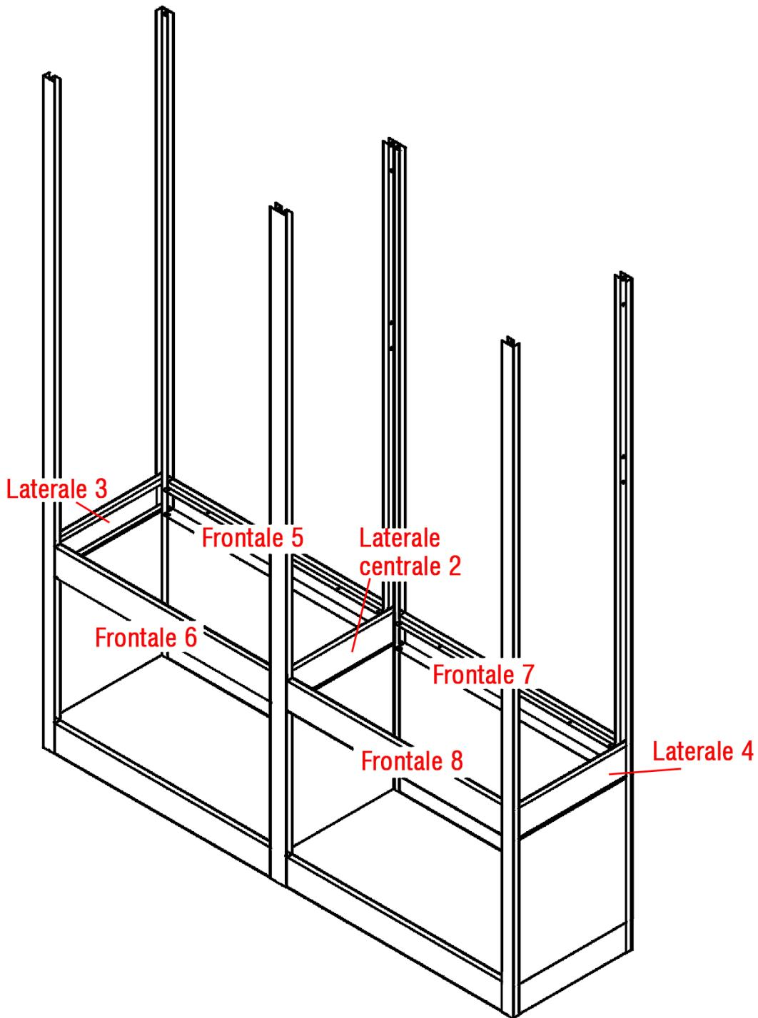
Inserire il laterale 3 e 4 , il frontale 5, 6, 7, 8 e il laterale centrale 2 tra i montanti a 2 vie e i montanti a 3 vie in modo analogo alle fasi 1, 2, 3 e 4.
