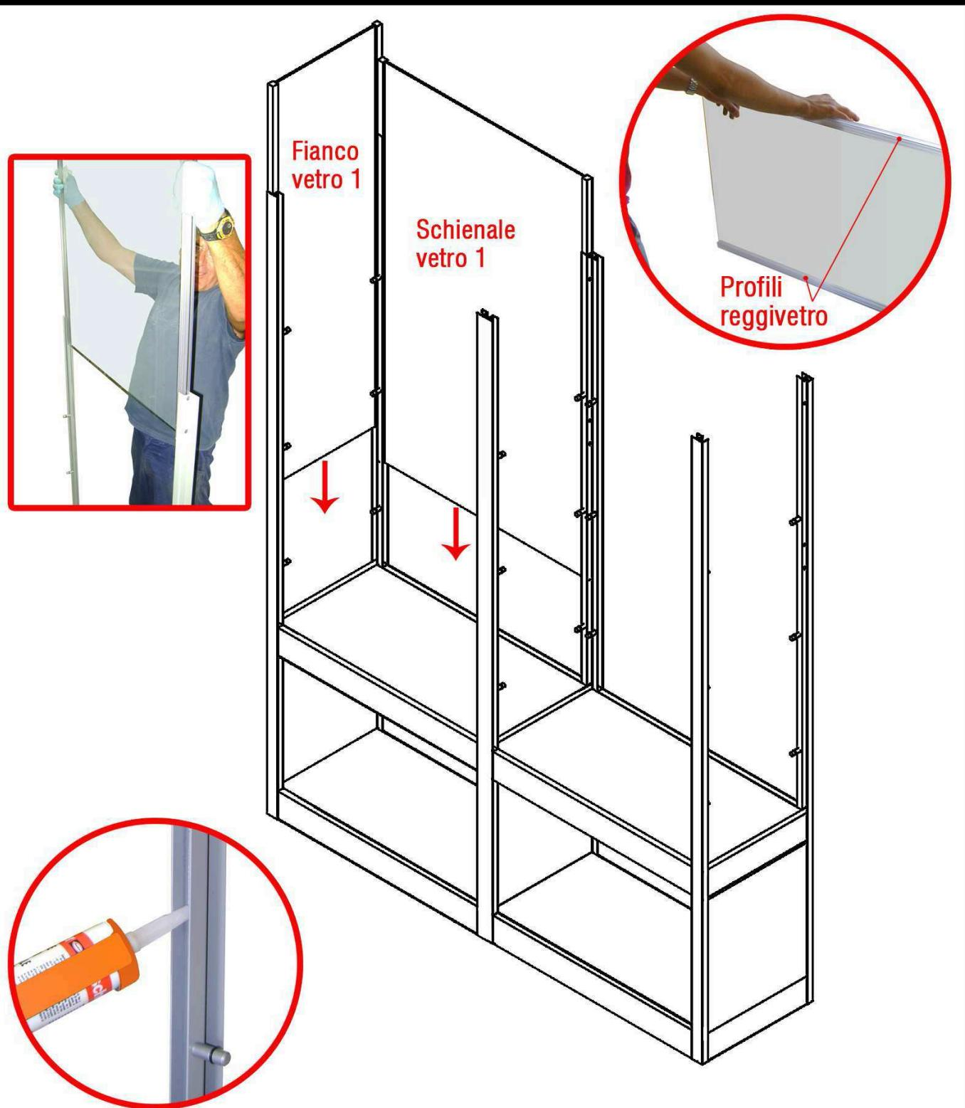
Stendere delle strisce di silicone all' interno dei montanti a 2 e 3 vie e inserire i fianchi e gli schienali in vetro ai quali, lateralmente, sono già stati inseriti i profili di plastica reggivetro
