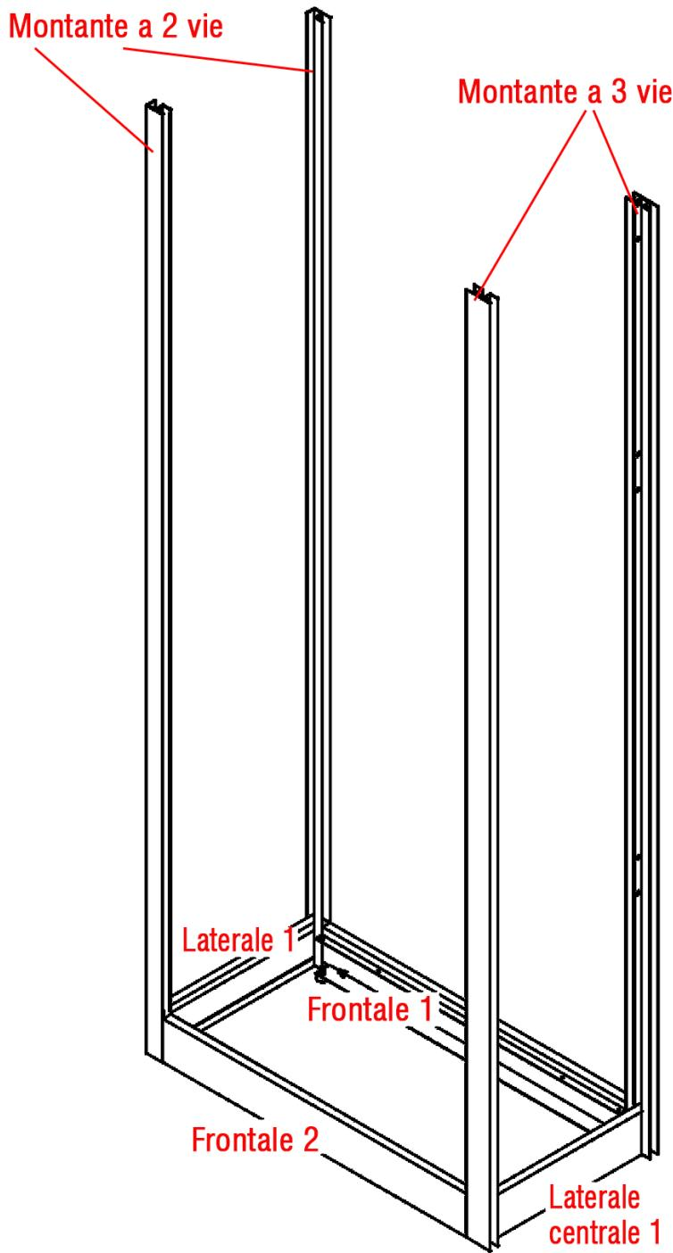
**Posizionare il secondo montante a 2 vie, poi il frontale 2. Bloccare i 3 oggetti (laterale 1, montante a 2 vie, frontale 2) mediante i bulloni diam.6 in dotazione (in entrambi i fori).**
