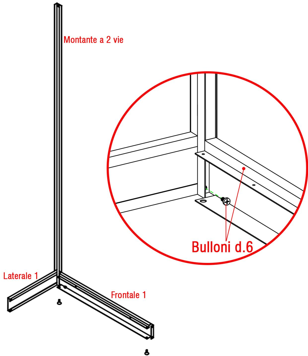
Posizionare il laterale 1 e il frontale 1 di metallo nel montante a 2 vie facendo combaciare i buchi. Bloccare i 3 oggetti mediante i bulloni diam.6 in dotazione (in entrambi i fori).
