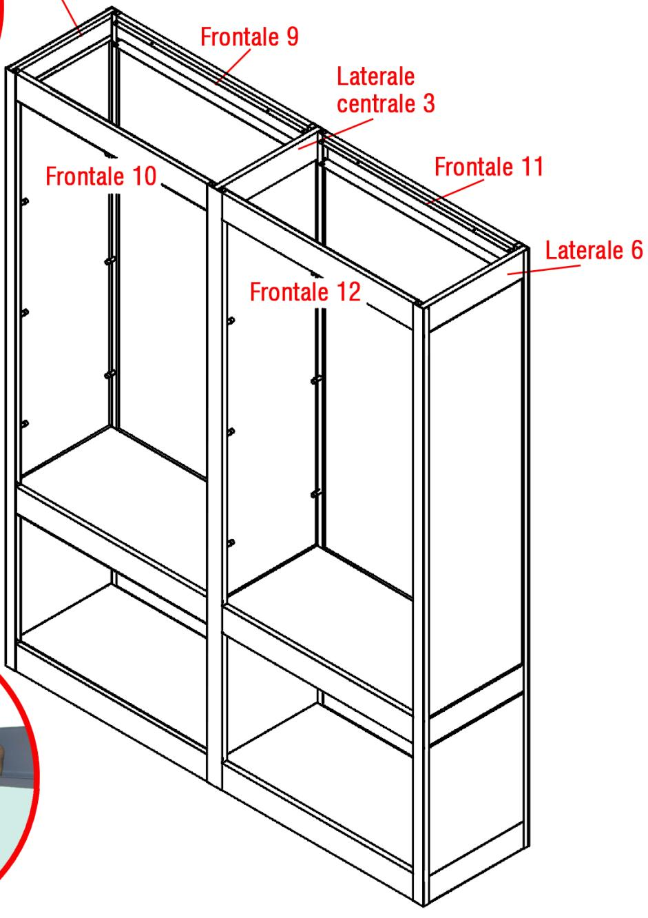
Completere la struttura inserendo il laterale 5 e 6 , il frontale 9, 10, 11 e 12 e il laterale centrale 3 tra i montanti a 2 vie e i montanti a 3 vie in modo analogo alle fase 6.
