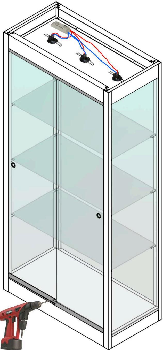
Completere il montaggio praticando il foro nella culotta interna che permetterà la chiusura a chiave delle antine.
